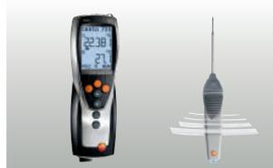
Sonde radio per misurazione senza fili per misurazioni aria/immersione/penetrazione
